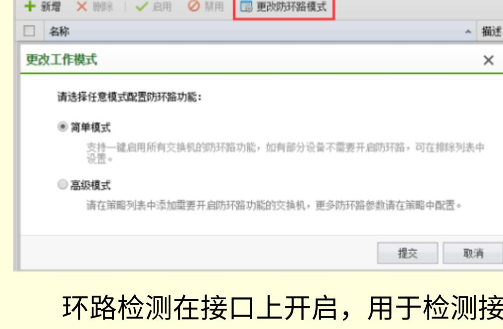
生成树的模式默认为高级模式，在右上角的更改防环路模式可以更改为简单模式。简单模式默认开启的生成树为MSTP，使用的是独立域，可配置内容较少。切换为简单模式后在左下角的更改防环路模式可切换回高级模式。
