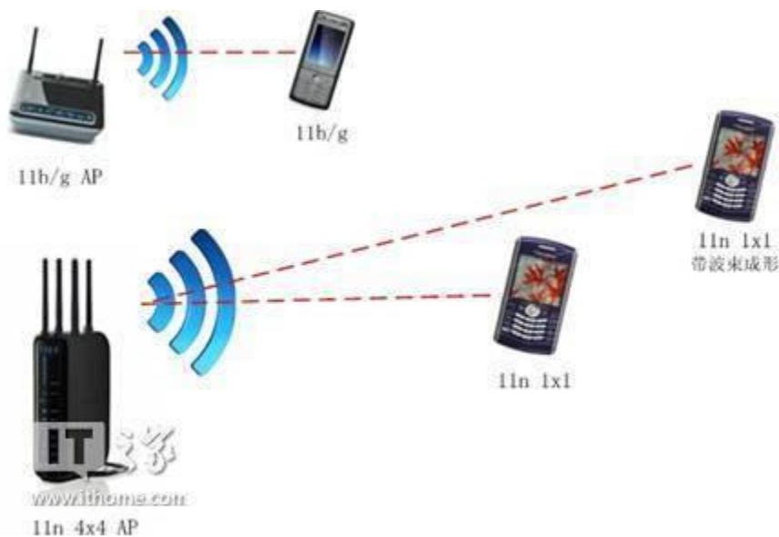
▲波束成形技术增加传输距离的示意图（图片来自网络）
